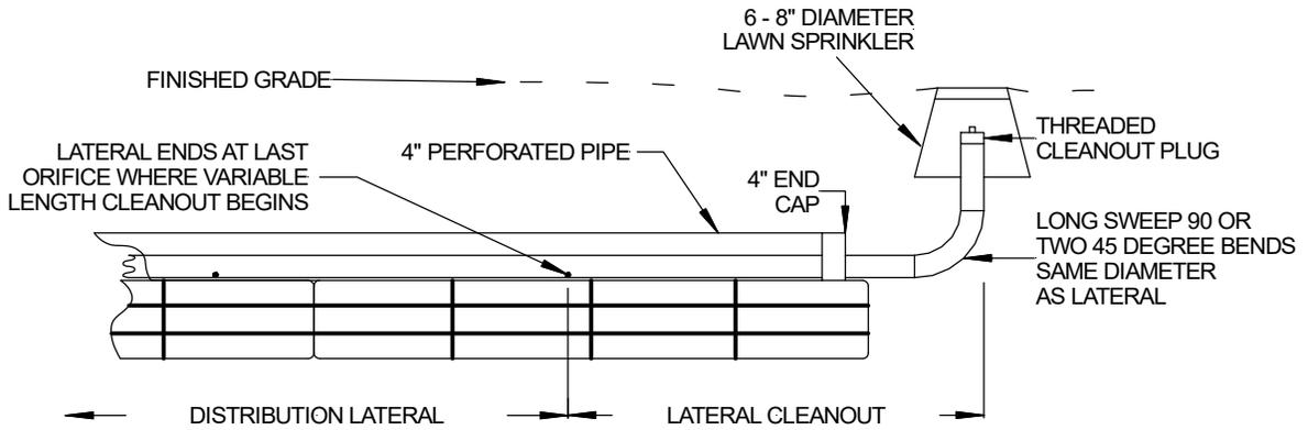
FIGURE 15: CONTOURED TRENCH PRESSURE DISTRIBUTION
